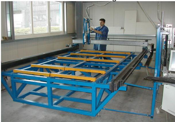
Insourcing statt outsourcing! Die neue Fräsanlage mit größeren Verfahrenswegen erhöht die Möglichkeiten der Fertigung im eigenen Hause. Weiters kann die Fräsanlage vom Tisch getrennt und als mobile Fräsanlage zum Fräsen und Bohren von Maschinengestellen verwendet werden.
